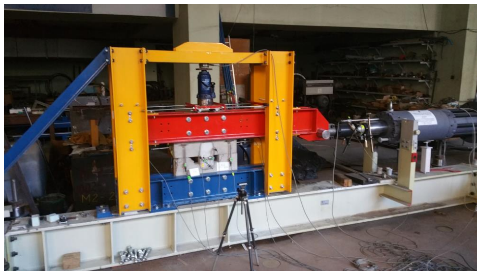
Фиг. 4. Изпитвателна постановка на хоризонтално съединение
