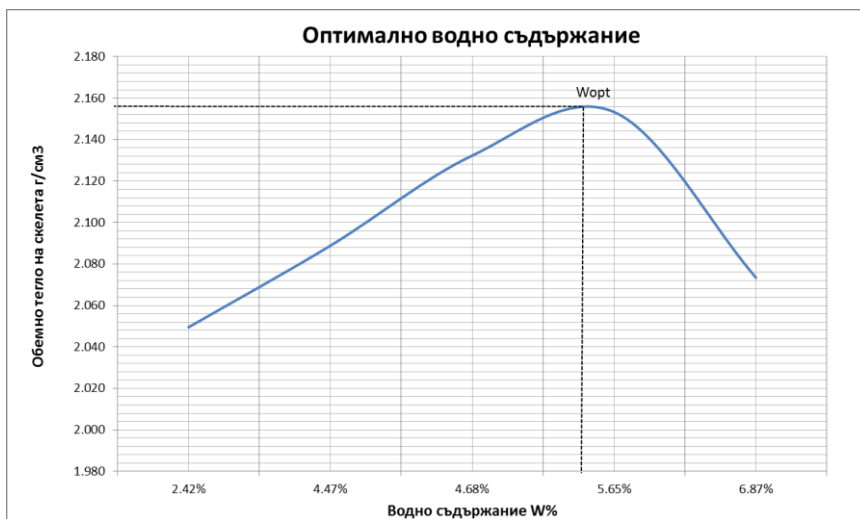
Фиг. 4. Графично представяне на максималната обемна плътност на скелета и оптималното водно съдържание на сместа
