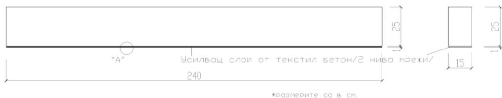
Фиг. 2. Схема на усиляването на стоманобетонните греди с текстилно армиран бетон
