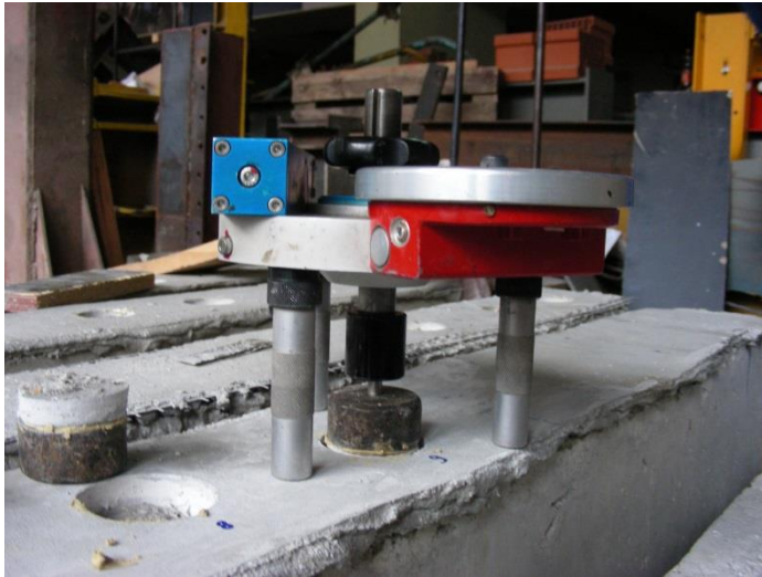
Фиг. 4. Изпитване на сцеплението между текстилно армиран бетон
