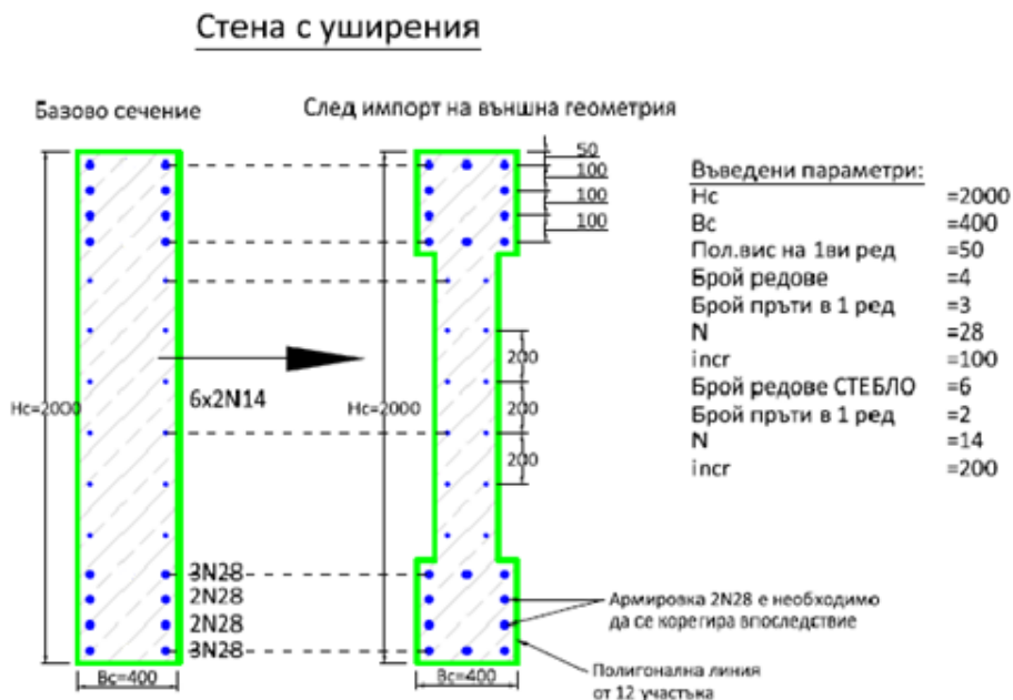
Фиг. 2. Примерни параметри за въвеждане на базово сечение за стена
