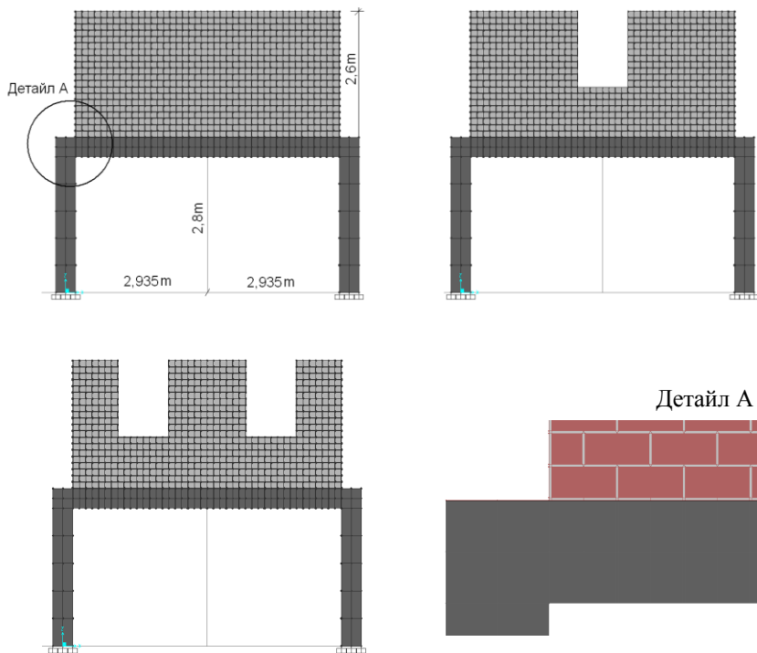
Фиг. 1. Схеми на стоманобетонна рамка, натоварена с тухлен зид без и със отвори
