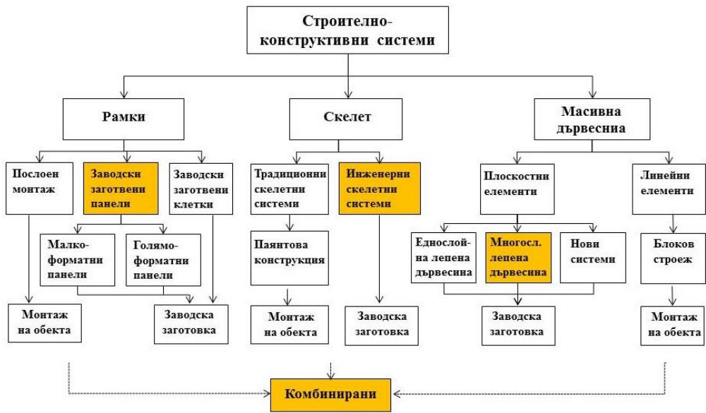
Фиг. 2. Строително-конструктивни решения при дървена носеща конструкция (източник: Holzforschung Austria)
