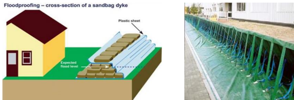
Фиг. 7. Изграждане на временна защита с чували с пясък и модулни панели
