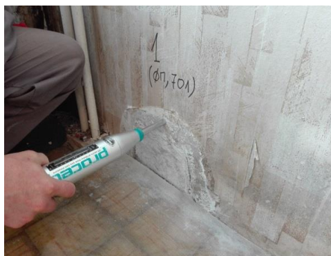
Фиг. 6. Определяне на вероятната якост на натиск
