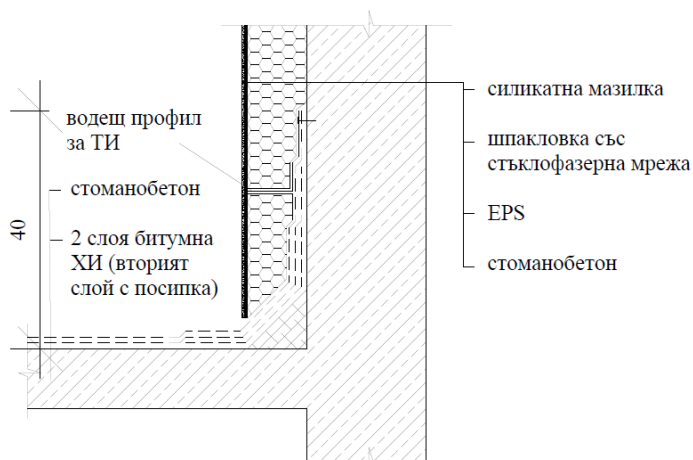
Фиг. 21. Примерен детайл за изпълнение на връзката стенен панел-покривен панел
