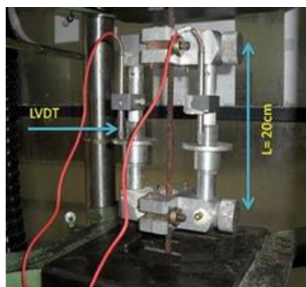
Фиг. 4. Екстензометър с два LVDT по време на изпитване, скорост 0,6 mm/min, [6]
