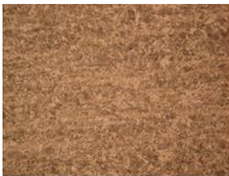
Фиг. 7. Фрактографска повърхнина на арматурна стомана в област 224,3 МПа
