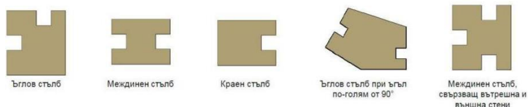
Фиг. 4. Напречни сечения на различни видове стълбове
