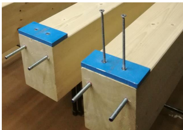
Сн. 3. Винтове за предотвратяване на появата на надлъжна пукнатина
