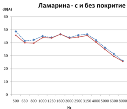
Фиг. 3. Звукопреминаване по честоти през ламарина със и без нанопокритие
