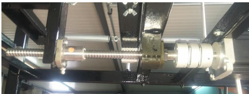
Фиг. 4. Експериментална система за преобразуване на ротационното движение в транслационно
