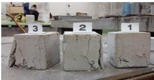
Фиг. 3. Опитни образци за определяне на характеристиките на разтвора
