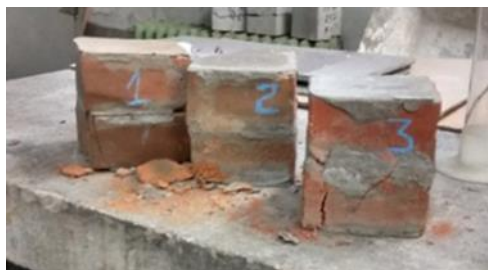
Фиг. 2. Опитни образци за определяне на опитните характеристики на зидарийни тела
