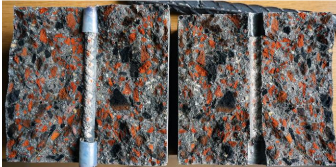
Фиг. 7. Повърхност на изтръгване на състав Б7 100/400/0,45
