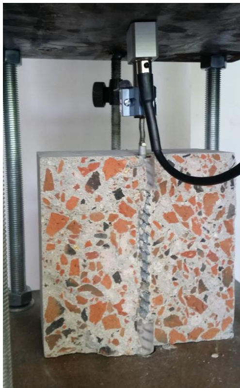
Фиг. 5. Постановка за определяне на приплъзването при изтръгване (снимка след допълнително разцепване на пробното тяло)
