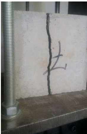
Фиг. 9. Разцепване на пробното тяло при изпитване на изтръгване (Б7/100/400/0,45)
