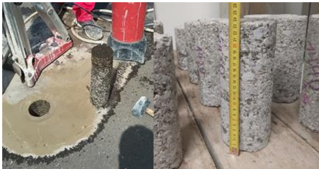
Фиг. 2. Пробни ядки от пътната конструкция
