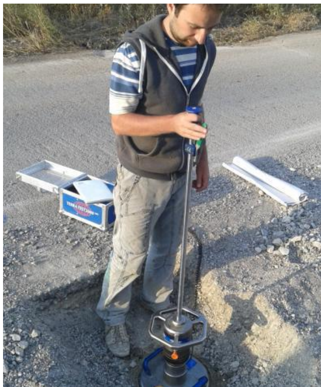
Фиг. 1. Измерване на носимоспособността под предвидената дебелина на стабилизацията
