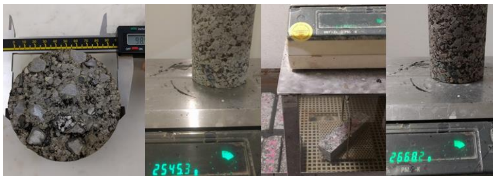
Фиг. 7. Измерване на геометрията и теглото на пробно тяло в три състояния
