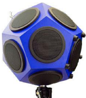
Фиг. 1. Снимка на използваните високоговорител – додекаедър и шумомер
