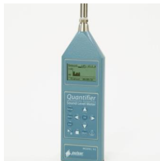
Фиг. 1. Снимка на използваните високоговорител – додекаедър и шумомер
