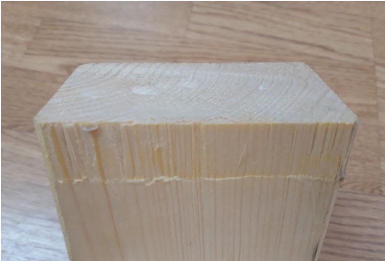
Фиг. 14. Разрушение на образца – срязване на дървесината
