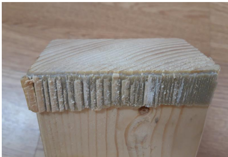
Фиг. 13. Разрушение на образца – лепилният слой е непокътнат
