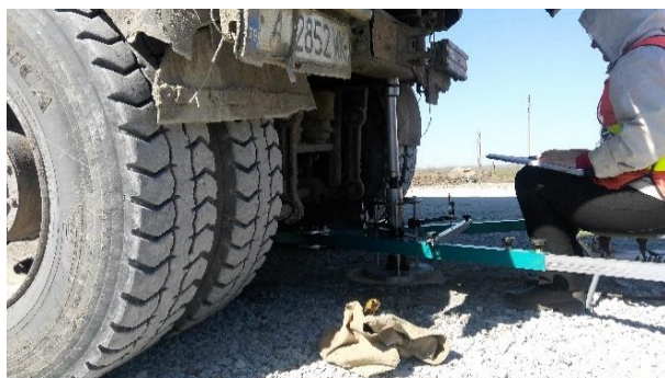
Фиг. 4. Натоварване с натискава плоча
