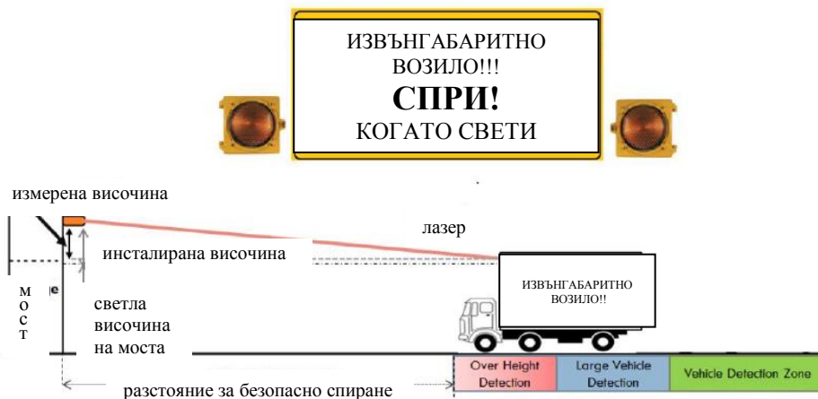
Фиг. 8. Електронна система за засичане на извънгабаритни автомобили [12]
