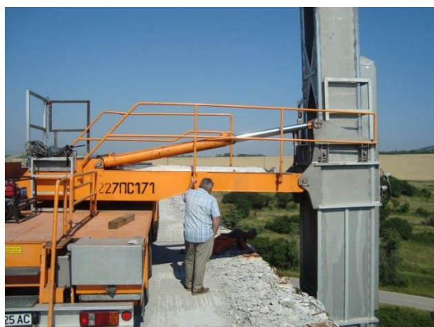
Фиг. 6. Ревизионен автомобил с хоризонтално положение на платформа за достъп
