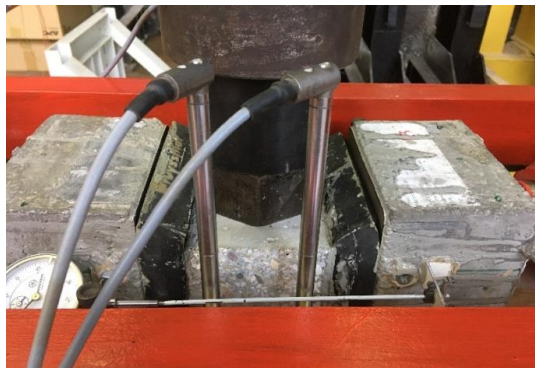
Фиг. 11. Срязване в лепилния слой при при нормална сила P = 25 \text{ kN}
