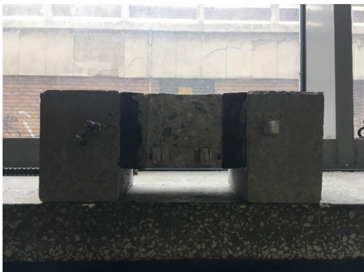
Фиг. 13. Опитни образци след снемане от постановката при нормална сила P = 65 \text{ kN}
