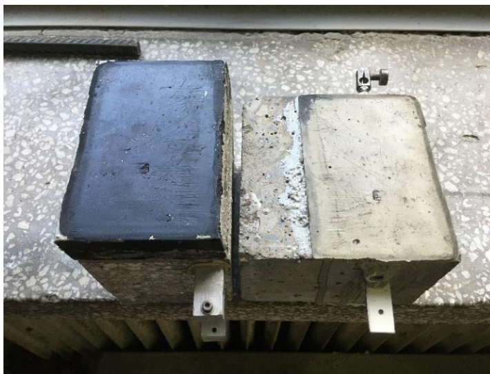
Фиг. 12. Опитни образци след снемане от постановката при нормална сила P = 25 \text{ kN}
