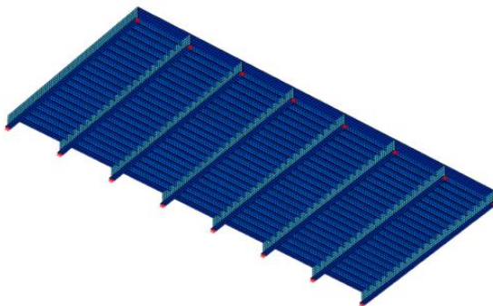
Фиг. 5. Модел по МКЕ на фрагмент от ОПШ на Виадукт 2
