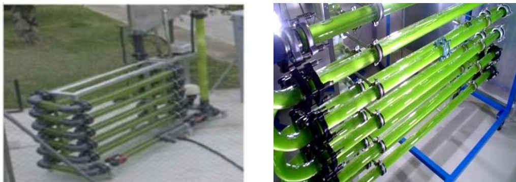
Фиг. 3. Лабораторни установки на тръбни фотобиореактори [9, 20]
