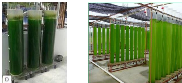
Фиг. 5. Лабораторни установки на цилиндрични фотобиореактори [21, 22]
