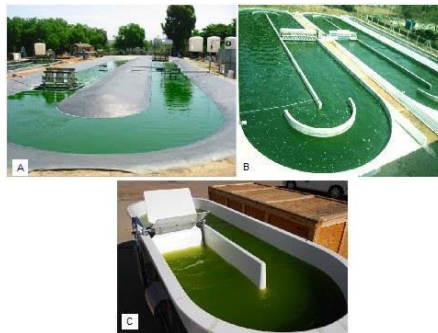
Фиг. 1. Лабораторни и пилотни инсталации на открити биореактори с алги, без допълнително аериране с въздух, богат на \text{CO}_2 [25]
