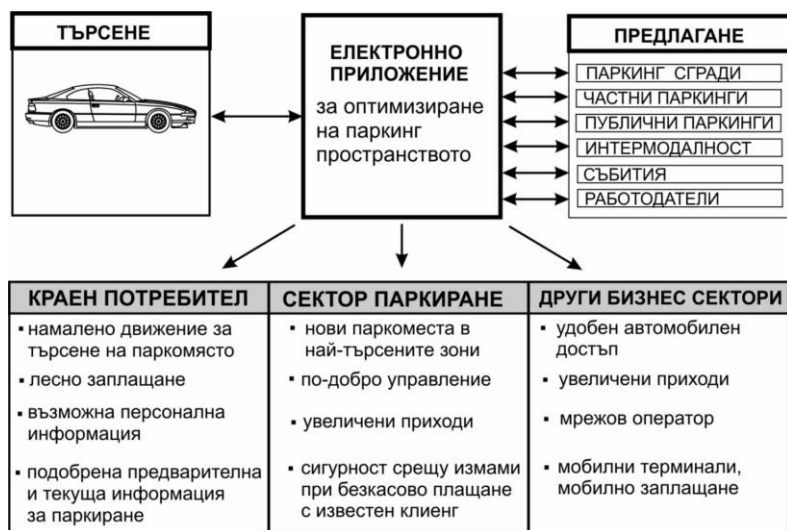
Фиг. 8. Принцип на действие и ползи от електронно приложение за оптимизиране на паркирането
