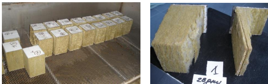
Фиг. 4. Опитни образци от сандвич панели с минерална вата, престояли 28 дни в температурно-влажностна камера (вляво) и разрушен образец, подложен на опън
