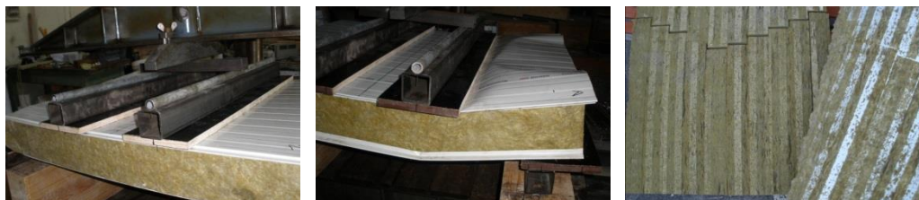
Фиг. 5. Изпитване на сандвич панели на срязване: вляво – начало; в центъра – край на експеримента; вдясно – срязаната от хлъзгане минерална вата
