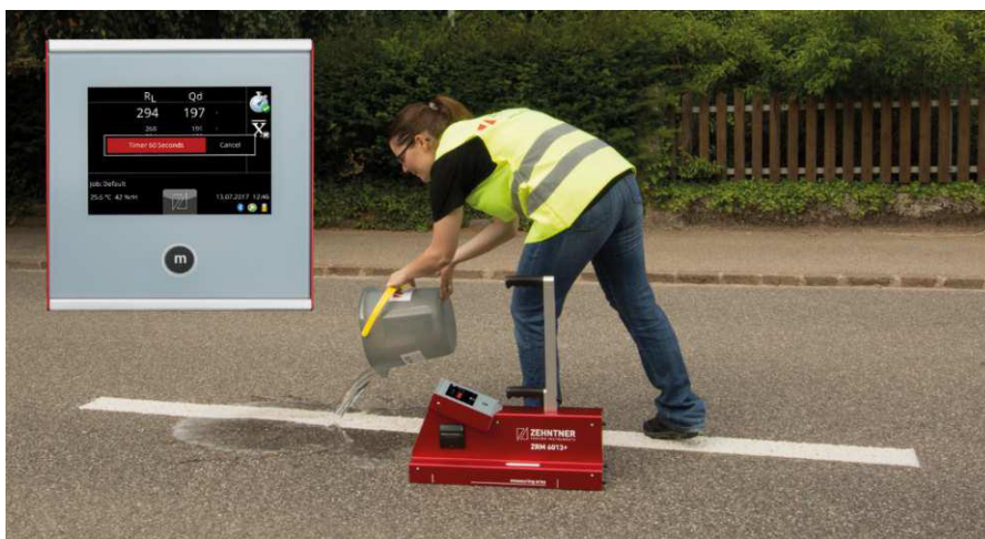
Фиг. 2. Измерване на светлоотражението при влажни условия с ретрорефлектометър на ZHENTNER, вж. [11]
