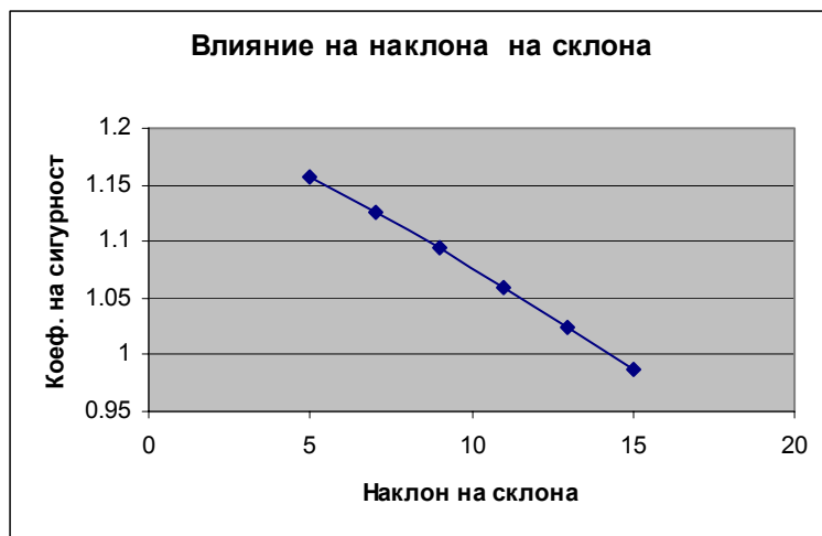
Фиг.8. Влияние на височината на откоса (а), влияние на обемното тегло (б) и влияние на наклона на склона върху коефициента на сигурност на откоса
