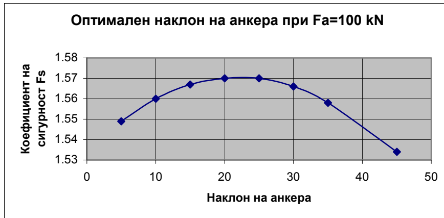
Фиг. 4. Изменение на коефициента на сигурност в зависимост от наклона на анкера спрямо хоризонта
