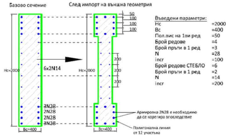
Фиг. 2. Примерни параметри за въвеждане на базово сечение за стена
