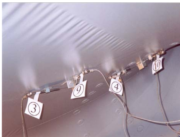
Фиг. 5.88: Наличие на гънки в тангенциална посока след напъгането
