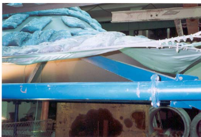
Фиг. 5.90: Задържане на провисванията от ъгловият обтегач
