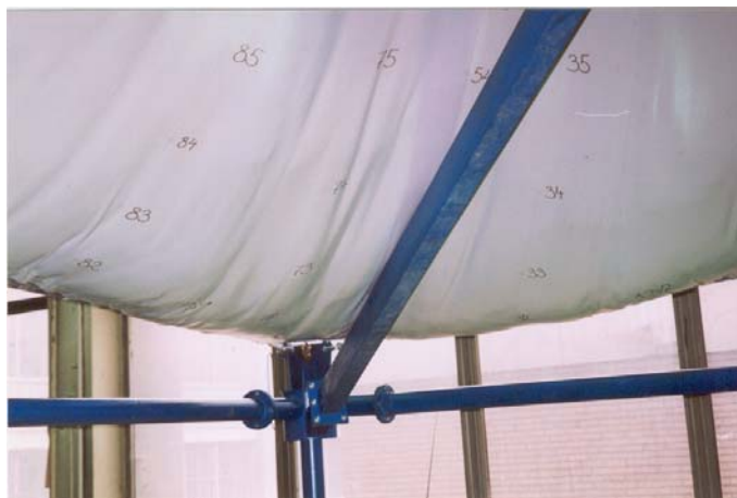
Фиг. 5.93: Опирание на мембраната в диагонала на рамката при натоварване
