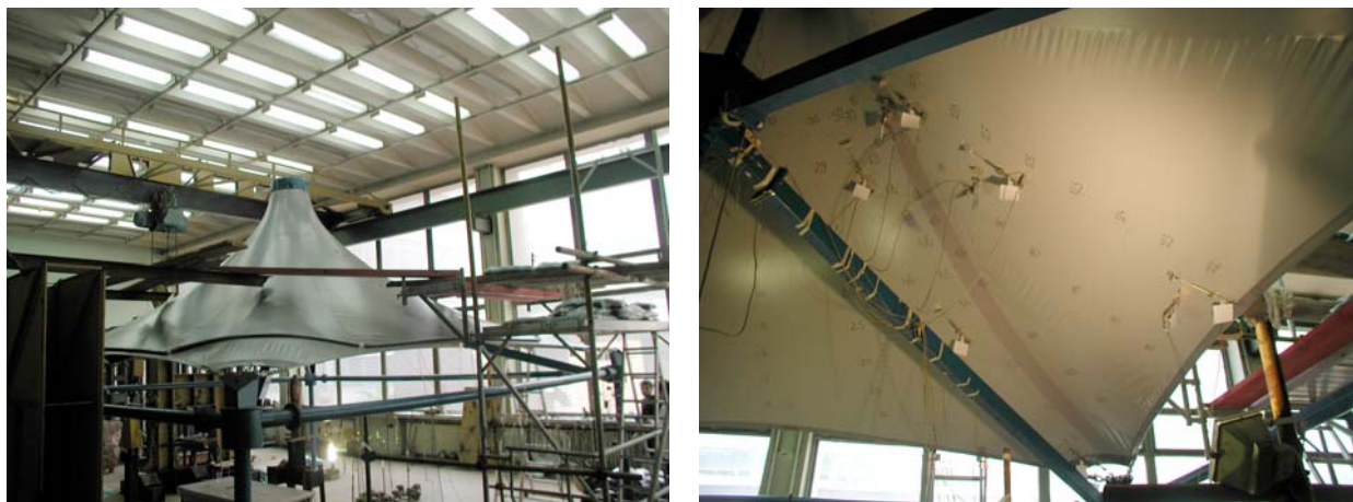
Фиг. 5.87: Мембраната в процес на налягане
