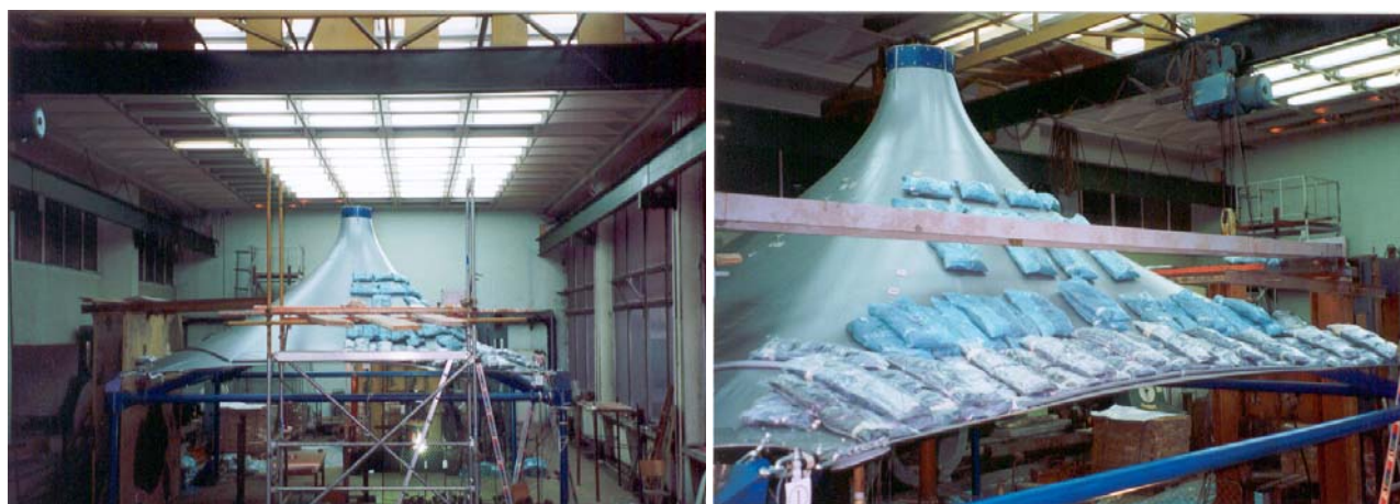
Фиг. 5.91: Несиметричен товар върху \frac{1}{2} и \frac{1}{4} от мембранната повърхнина
