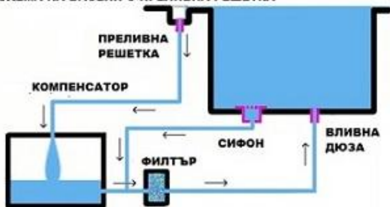
СХЕМА НА БАСЕЙН С ПРЕЛИВНА РЕШЕТКА
