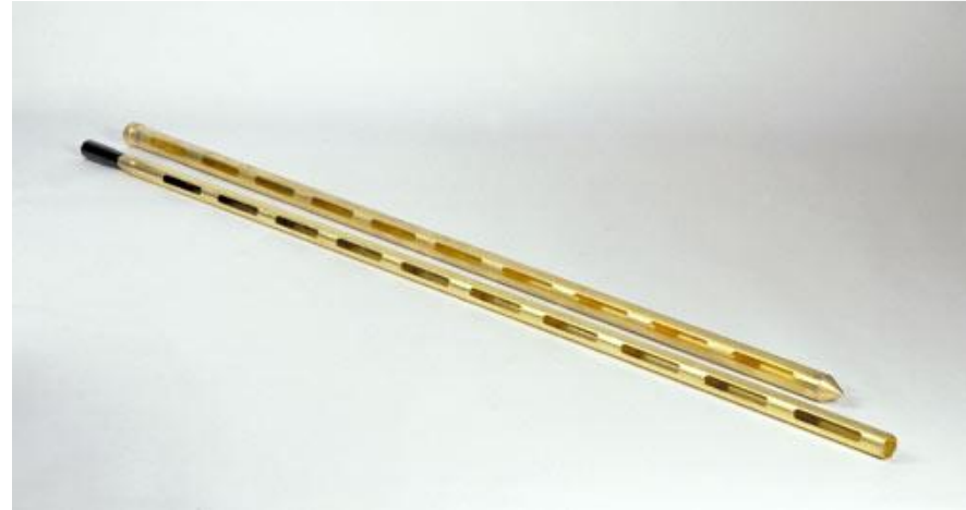
Принципна схема и общ вид на прибор за вземане на проба от цимент
