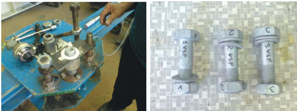
Фиг. 2. Опитна постановка – ляво, Изпитвани болтове - дясно.
